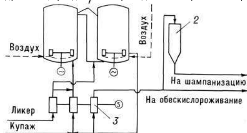
Рис. 4. Аппаратурно-технологическая схема двухстадийного культивирования дрожжей гомогенно-непрерывным способом (по Н. Г. Сарихвиль): 1 — дрожжевой аппарат; 2 — активатор; 3 — дозирующий агрегат
